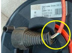
Verwenden Sie keine elektrischen Geräte, die sichtbare Beschädigungen aufweisen. Zusätzlich zur Brandgefahr besteht die Gefahr eines Elektrounfalls für den Benutzer.
