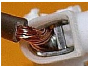
Elektrisches Installationsmaterial ist frei käuflich, aber unfachlich ausgeführte Reparaturen können einen Brand auslösen.
