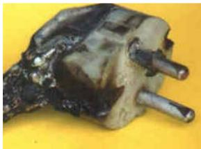
Auch wenn Störungen an elektrischen Einrichtungen nicht zu einem Brand mit offener Flamme führen, werden durch die Hitze oft umgebende Isolationsteile zerstört, die dabei giftige Gase freisetzen.
