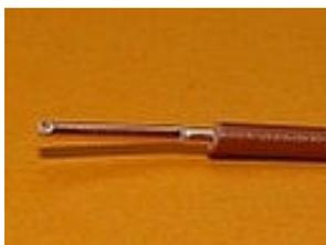
b.) Die Einkerbung in diesem Kupferleiter stellt eine Sollbruchstelle dar und reduziert durch Materialverschiebung den Querschnitt mit den bereits benannten Folgen.
