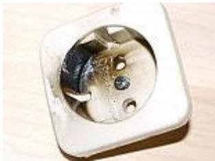
Wenn Steckdosenabdeckungen dunkle Verfärbungen um die Kontaktlöcher aufweisen, (nicht erst so extremen Verfärbungen wie abgebildet), sollten diese nicht mehr benutzt und die Steckdosen kurzfristig von einem Fachmann überprüft und ggf. erneuert werden, um einem Brand durch schlechte Kontaktstellen vorzubeugen.
