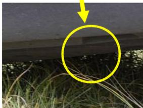
Immer wieder führen heiße Katalysatoren oder Russpartikelfilter zum Entzünden der Materialien unter dem Fahrzeug.
